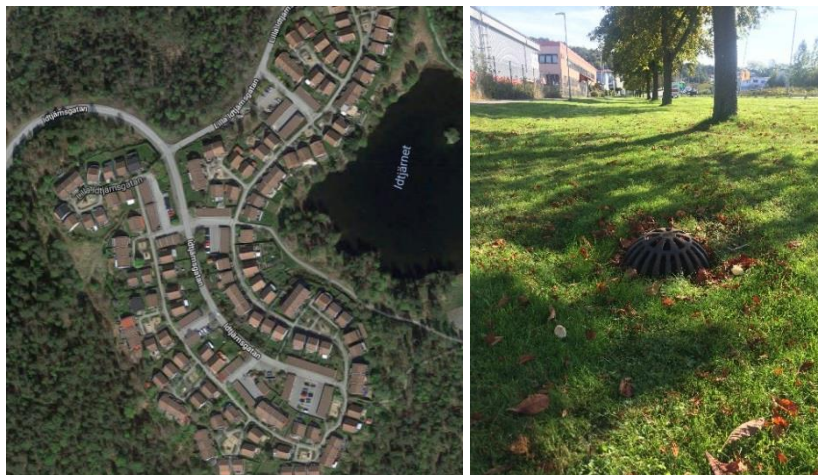
Figur 2 Bilden till vänster visar villaområdet vid Idtjärnet i Rannebergen som är ett typiskt exempel på en mindre belastad yta. Bilden till höger visar exempel på en översilningsyta som är en lämplig reningslösning i detta typ av område.
