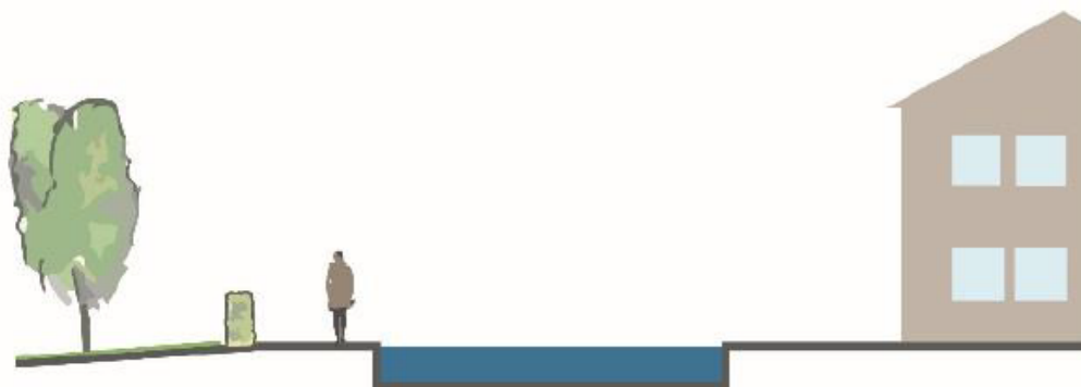
Figur 7. Bilden visar en nedsänkt väg som därmed också fungerar som skyfallsled vid extrema regn.
