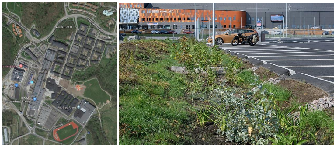
Figur 3 Bilden till höger visar Angered centrum som är ett exempel på en medelbelastad yta. Till höger visas en bild på regnrabatten vid Kvibergs arena som är ett exempel på lämplig dagvattenrening i detta typ av område.
